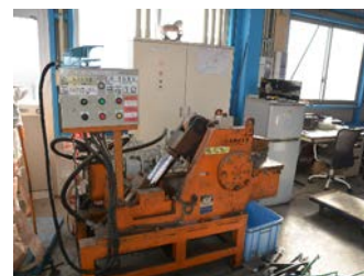
各種非鉄金属切断設備 処理能力：4.75 t 金属くず
