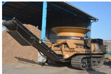
木くずの破碎施設(MC6000) 処理能力 75.68 t / 日
