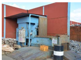
小型金属プレス機 処理能力：271.2 t/日
