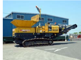
BR-300S ガラパゴス移動式万能破砕機 処理能力130 t/日
