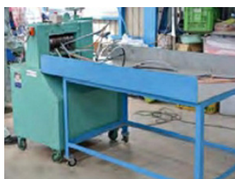
電線類剥離施設 処理能力：3.02 t/日(金属くず)
