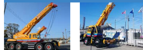
75tラフテレーンクレーン 1台 13tラフテレーンクレーン 1台
