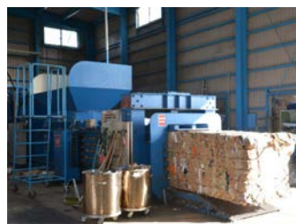
万能ジャンボプレス機 処理能力(紙類)：269.2t/日 (衣類)：206.2 t/日
