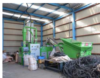
銅線ナゲット処理機 処理能力：300kg/h
