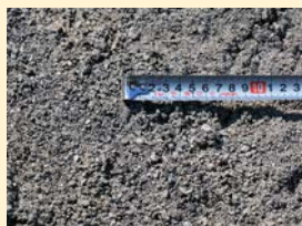
アスファルト破碎品
